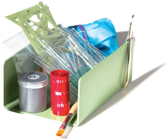
Oben: Utensilien im DIY-Kit zum Selbstbau eines Dielektrischen Elastomerwandlers. Rechts: Bilder in der Anleitung zum prinzipiellen Aufbau eines einfachen Dielektrischen Elastomerwandlers
