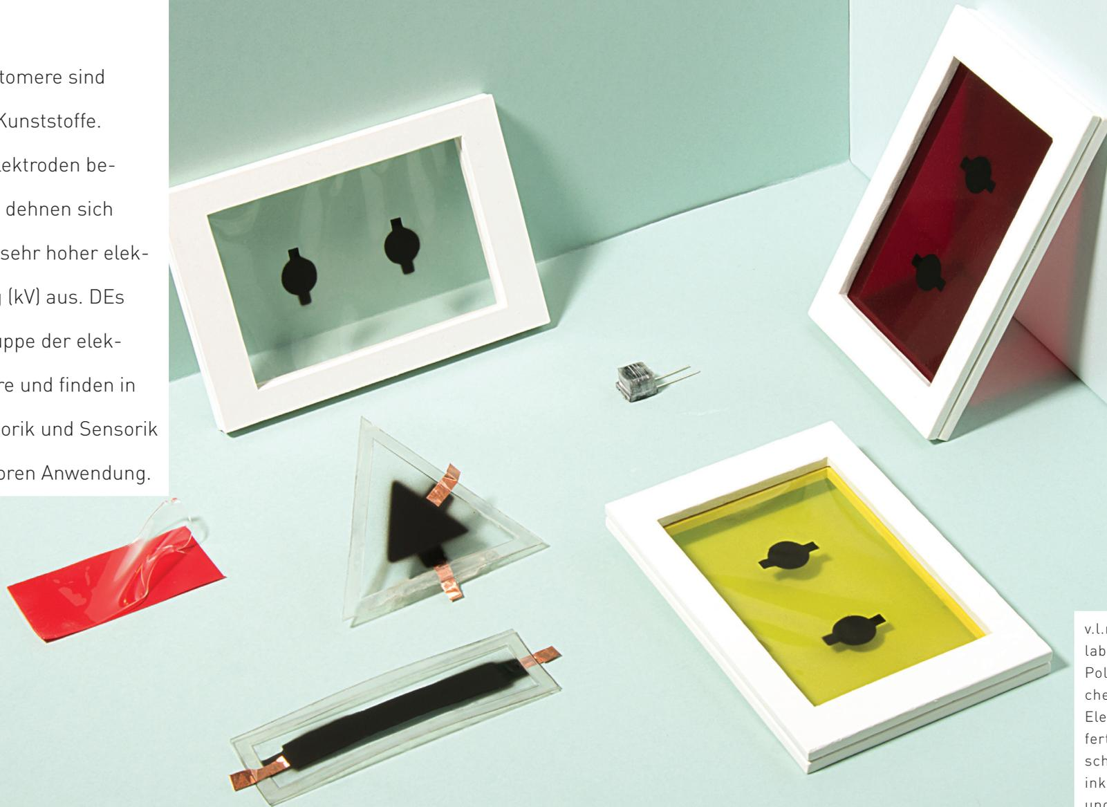
v.l.n.r.: 3M-Polymerfolie, laborgefertigte DE-Proben aus Polymerfolien mit unterschiedlichen Eigenschaften inklusive Elektroden (schwarz), handgefertigte DE-Proben mit unterschiedlichen Rahmenstrukturen inklusive Elektroden (schwarz) und Kupferkontakten, laborgefertigter Stapelaktor
