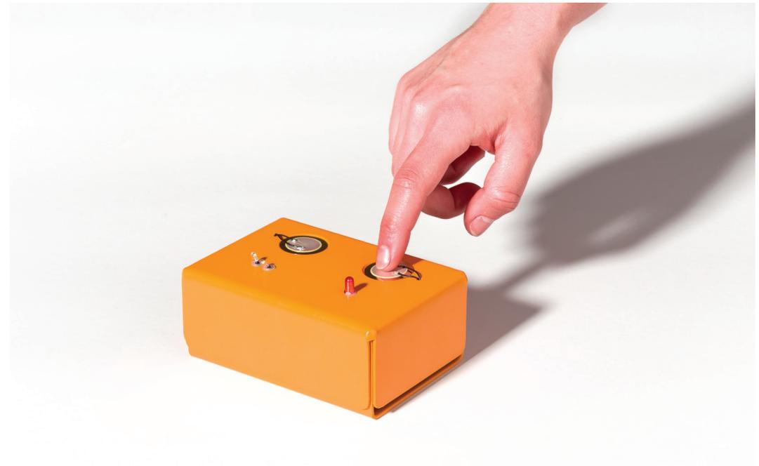
Piezo-Generator: Bei Klopfen auf die Piezo-Scheibe leuchtet die LED
