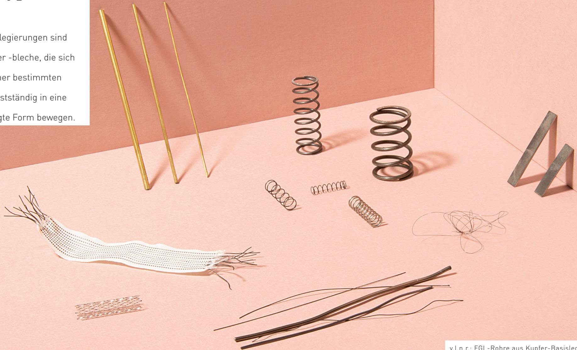
v.l.n.r.: FGL-Rohre aus Kupfer-Basislegierung, NiTi-Legierungen als Federelemente, FGL-Bleche und -Drähte, Stent aus superelastischem FGL, Gewebe mit integrierten FGL-Drähten
