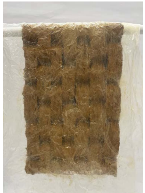
[4] Hängende Durchtrocknung, Abgedeckt
