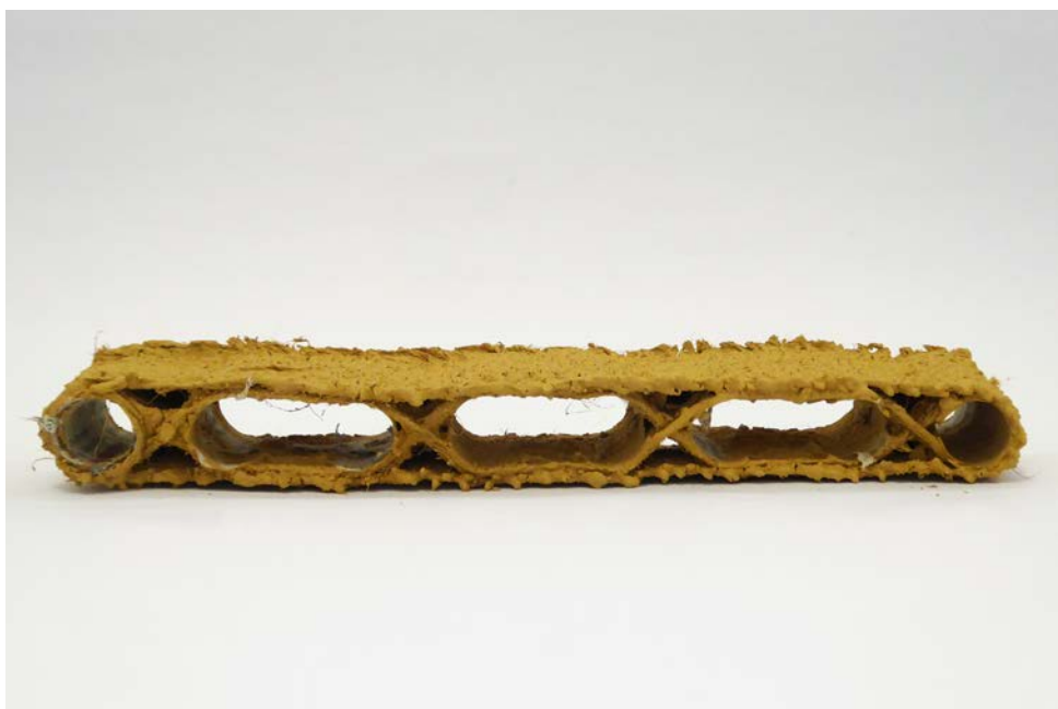
[6] Getrocknete Probe mit feinen Rissen, Seitenansicht
