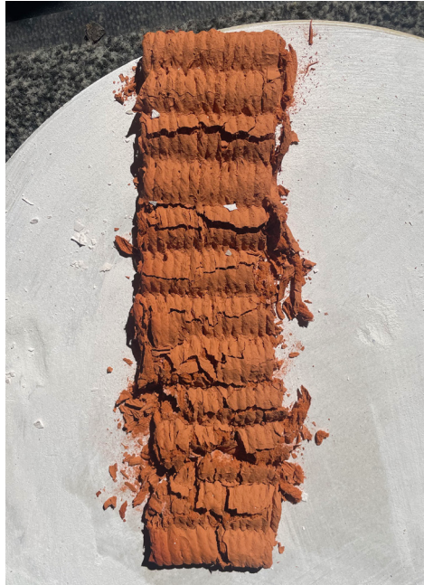
[6] Instabile Probe nach dem Schrühbrand
