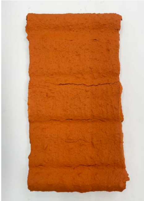
[6] Probe nach dem Schrühbrand, links: Seite mit weniger Rissen, rechts: Seitenansicht
