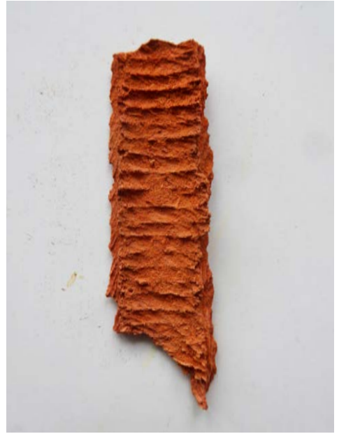
[6] Instabiles Resultat nach dem Schrühbrand
