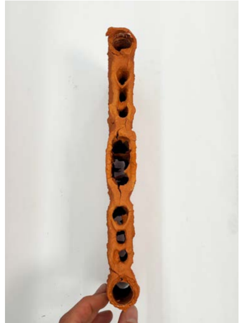
[6] Probe nach dem Schrühbrand, links: Seite mit weniger Rissen, rechts: Seitenansicht
