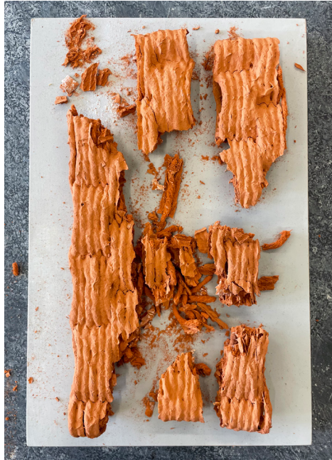
[6] Instabile Probe nach dem Schrühbrand
