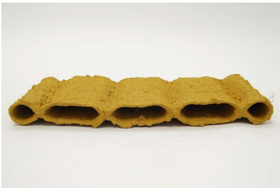
[6] Getrocknete Probe mit feinen Rissen, Seitenansicht
