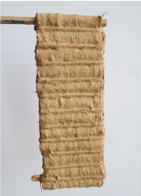
[5] Getrocknete Probe, Horizontale Risse
