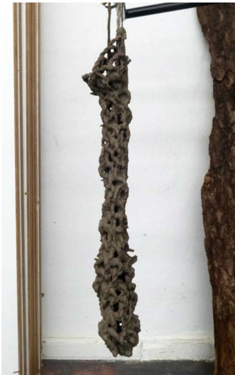
Gewobene Strohfasern, in Ton getaucht und hängend getrocknet
