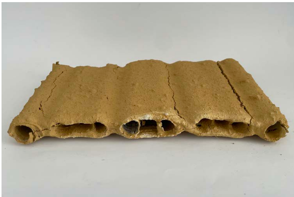
[5] Getrocknete Probe mit horizontalen Rissen
