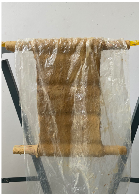
[4/5] Hängende Probe nach zweitem Eintauchen, abgedeckter Trocknungsprozess
