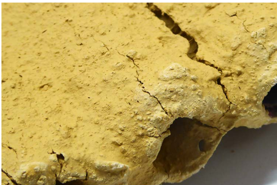
[5] Getrocknete Probe, Risse
