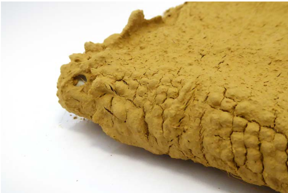
[6] Getrocknete Probe mit feinen Rissen, Seitenansicht
