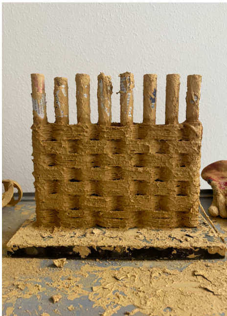
[3] Lederharter Zustand, Lösen der Rohre
