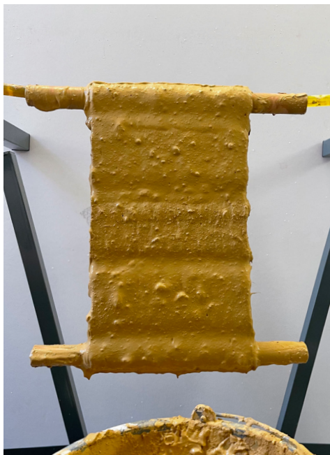
[4/5] Hängende Probe nach zweitem Eintauchen, abgedeckter Trocknungsprozess
