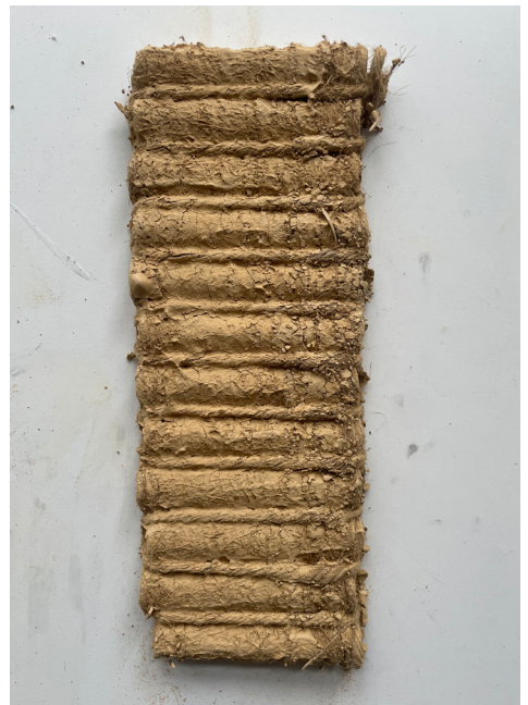
[3] Beschädigte Probe durch das Lösen vom Rahmen
