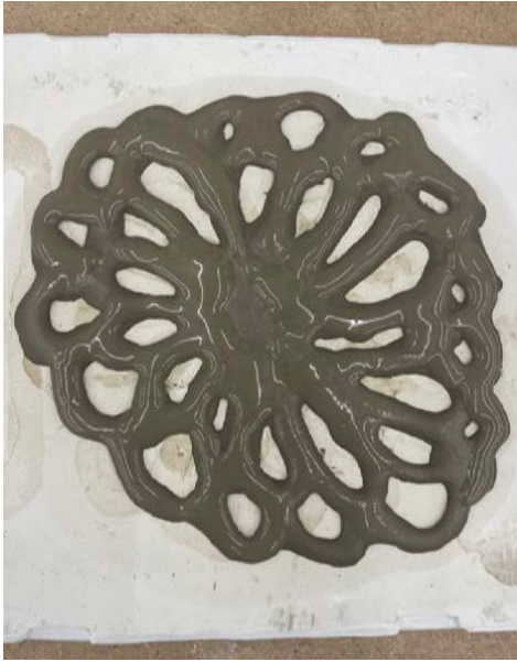
Mit Spritze auf Gipsplatte aufgebrachter Ton
