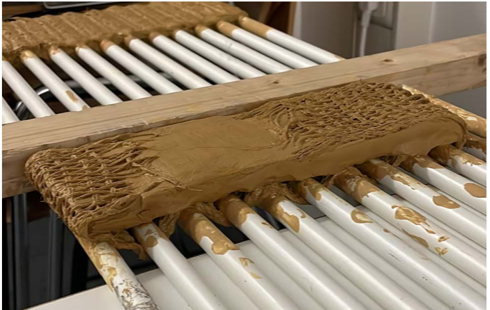
[1/2] abgeschlossener Webeprozess, angedrückte Ton-Scheibe, umgeschlagenes Jute-Band
