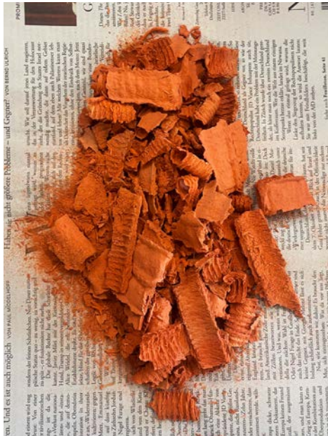
[6] Instabiles Resultat nach dem Schrühbrand
