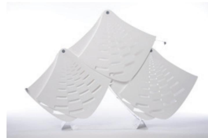
verschiedene mögliche Szenarien bei Erwärmung, teilweise unterschiedliches Verschieben der Module bis vollständiges simultanes Verschieben
