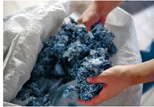
Vlies-Bandarbeit der anderen Art: Alte Jeans-Stoffreste werden, nachdem sie in ihre faserigen Teile zerkleinert wurden, zu einem neuen Vlies verarbeitet. © Jens Thomas
